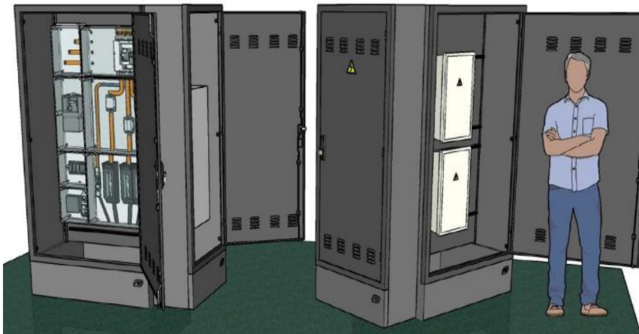
Figura 6. Detall armari prefabricat instal·lació d'enllaç
